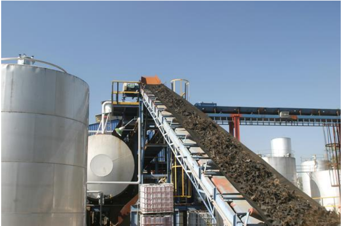
Figura 1.9 Proceso de separación de los componentes de la llanta a través de una trituradora.
