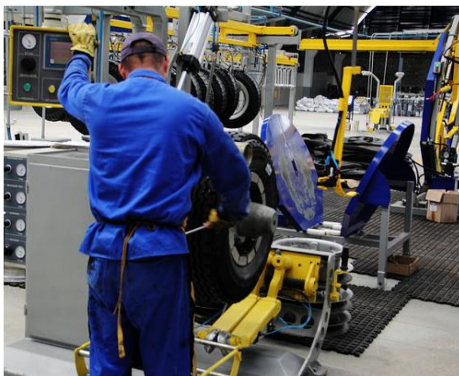
Figura 2.0 Proceso de reencauche de neumático usado.
