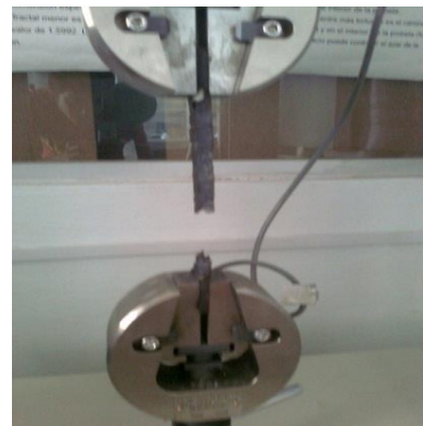
Figura 3.8 Fractura de la probeta
