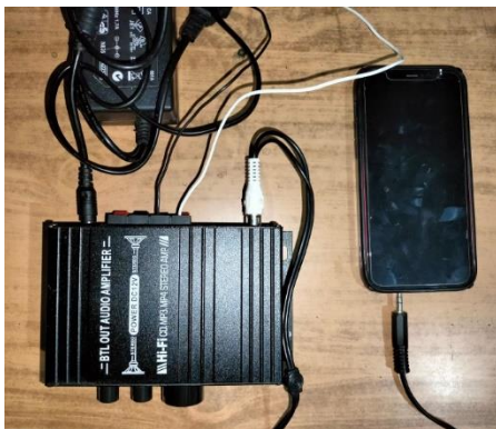
Fig. 5. Conexiones del amplificador con la bocina y celular para emitir la frecuencia.
