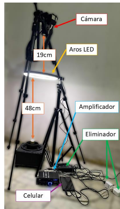
Fig. 7. Componentes en conjunto para el funcionamiento del sistema címático.
