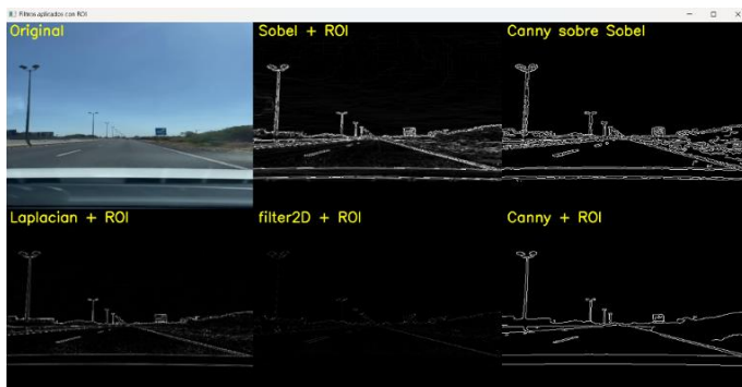
Fig. 2. Aplicación de filtros de detección de bordes.
