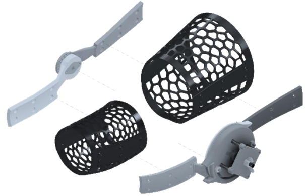
Fig. 1. Diseño de la órtesis de rodilla (Sánchez-Angeles, 2025).
