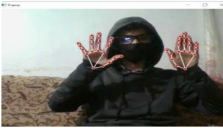
Fig. 7. Prueba de landmarks de manos (abierta y cerrada)
