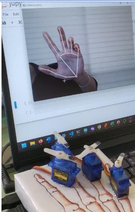
Fig. 3. Detección de mano y movimiento de un servomotor con diferentes dedos.
