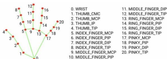
Fig. 3. Landmarks de la mano con 21 puntos de referencia
