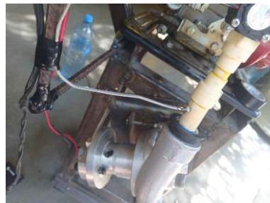
Fig. 9. Instalación del sensor de presión.
