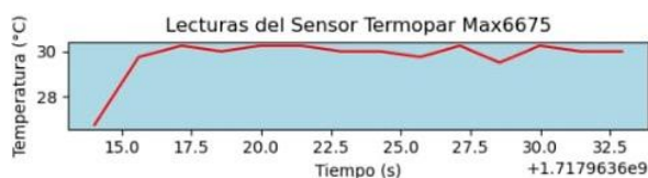
Fig. 16. Lectura de temperatura, con el motor apagado.
