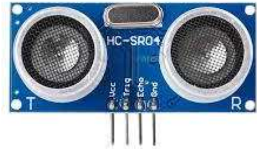
Figura 2. Sensor Ultrasónico Hc-sr04
