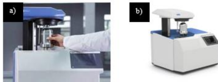
Figura 9. a) Colocación del recipiente de disgregación; b) Bomba calorimétrica.
