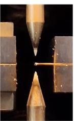
Imagen 3.- Formación de una microesfera por medio de arcos eléctricos de una empalmadora.
