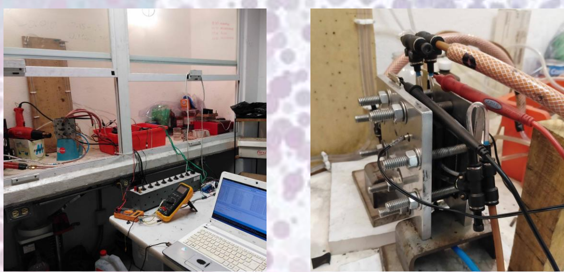
Figura 7 (a) Estación de pruebas experimentales, (b) Stack.
