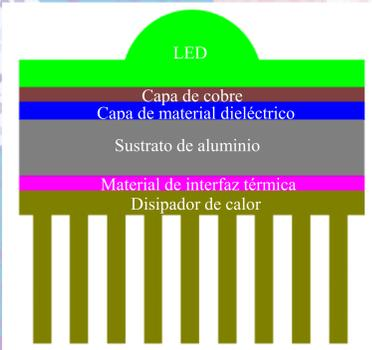
Fig. 2 – Diagrama esquemático de la composición de la PCB [3].
