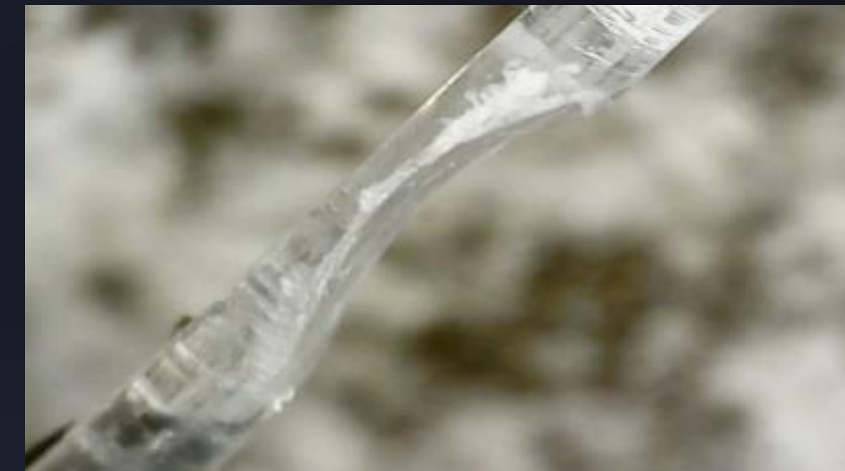
Fig 4. Desbaste de las fibras plásticas en forma de D.
