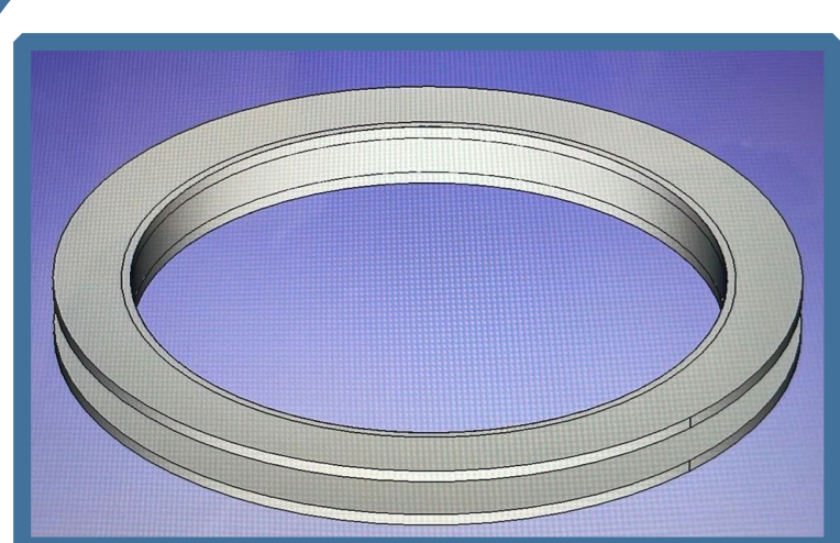
Fig. 8 Diseño de impresión 3D de la bobina, con un radio r=10\text{cm} .
