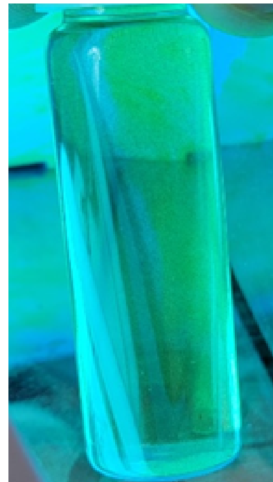
Figura 2. Líquido sobrenadante resultante de la síntesis por combustión (Abajo-Arriba), la cual se oxida por 18 hrs, expuesto a la luz UV.
