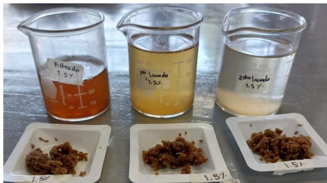
Figura 2. Filtrado y lavados de  $H_2SO_4$  al 1.5%
