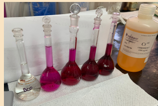
Imagen 1. Determinación de Cr(VI) por espectrofotometría de UV-Visible.
