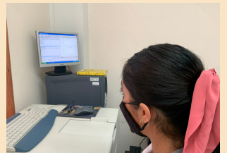
Imagen 1. Determinación de Cr(VI) por espectrofotometría de UV-Visible.
