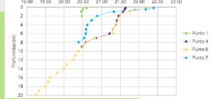
Figura 4. Variación vertical de la temperatura en los sitios de monitoreo en la presa La Purísima.
