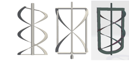
Fig 1. Dibujo en CAD de los tres diferentes agitadores, el inciso a muestra el dibujo en CAD del agitador ribbon; el inciso b muestra el dibujo en CAD del agitador Paravisc y finalmente el inciso c muestra el dibujo en CAD del agitador Híbrido.
