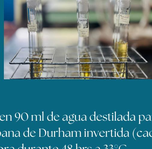
Se realizó una disolución de 3.29g de Caldo laurilsulfato en 90 ml de agua destilada para añadir 10, 1 y 0.1 mL en 9 tubos de ensayo con una campana de Durham invertida (cada cantidad en tres tubos), e ingresarlos a la incubadora durante 48 hrs a 33°C.
