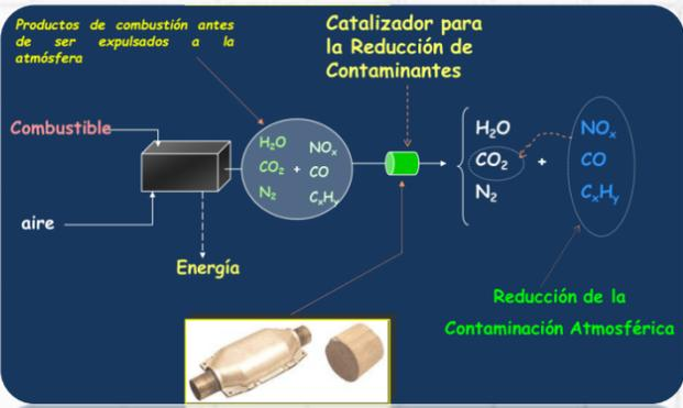
Un ejemplo es el convertidor catalítico usado en catálisis ambiental es aquel colocado en los automóviles.
