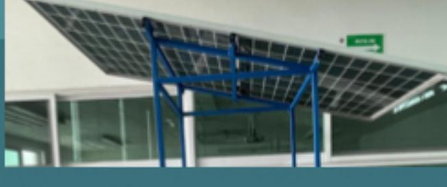
El panel tiene una inclinación de 30 a 45 grados, como se sugiere que sean instalados.
