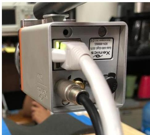
Figura 1. Conexiones de ethernet y corriente de la cámara infrarroja.
