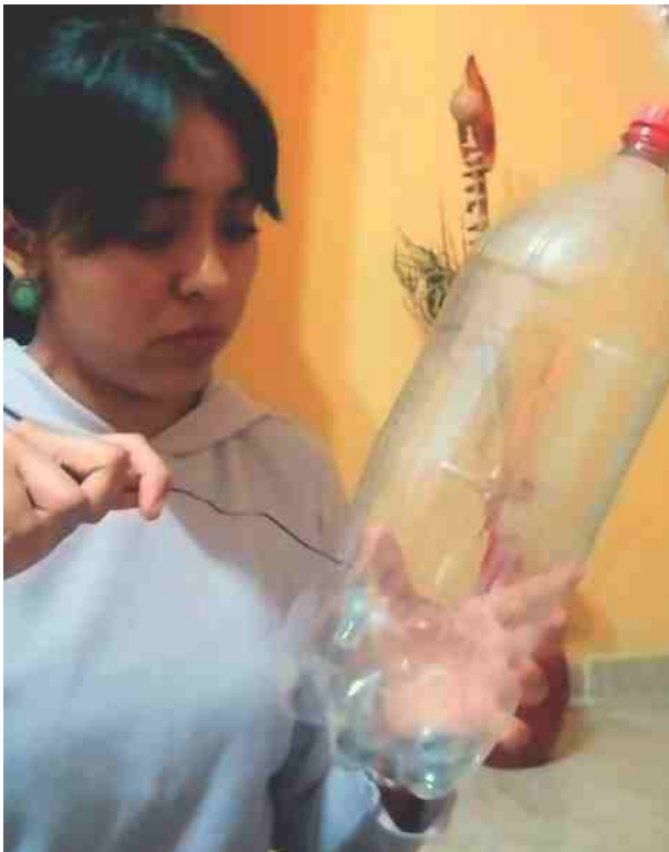
Figura 2. Realizando el orificio de salida de agua con un alambre caliente.
