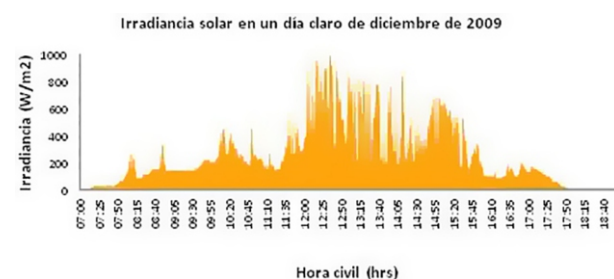
Figura 7. Irradiancia total solar sobre una superficie horizontal en un día nublado.
